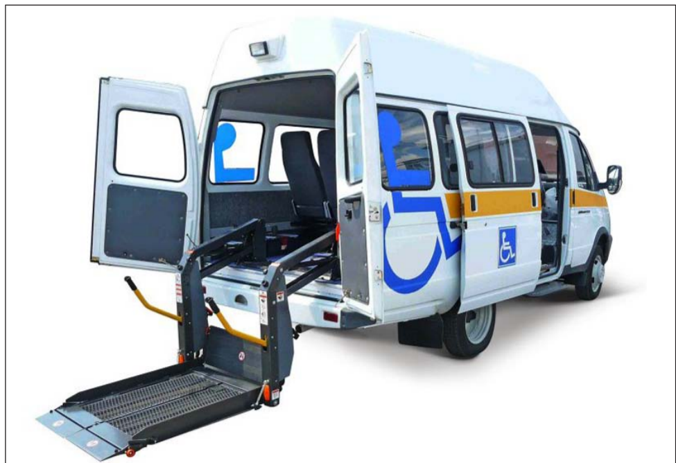
Микроавтобус «ГАЗель» с электроподъёмником, оборудованный для перевозки инвалидов в коляске
